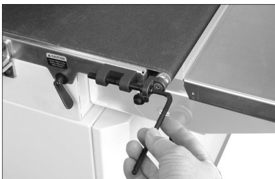
Рис. 8-3: регулировка натяжения ленты
