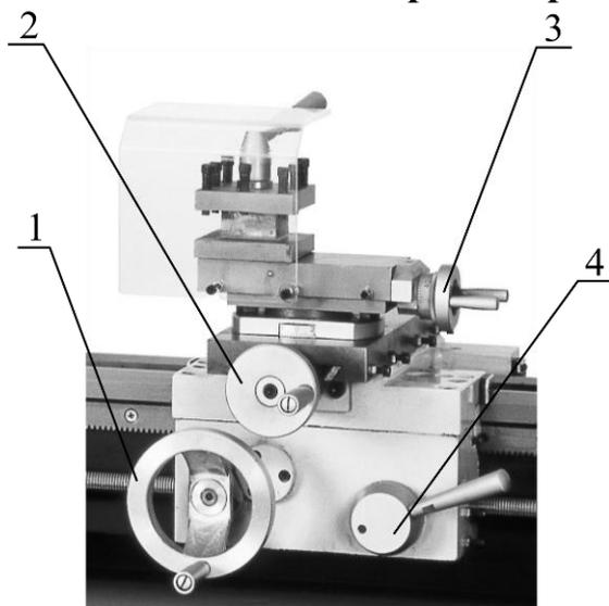
В первую очередь проверьте положение рукоятки включения и выключения гайки ходового винта 4, при ручной обработке гайка должна быть выключена.
