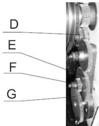
Для замены шестерен D, E, F, G открутите гайки перед шестернями (служащих для фиксации шестерен по оси валов). Снимите шестерни. Установите необходимые шестерни и зафиксируйте их на валах при помощи гаек. Для изменения межосевого расстояния между шестерен ослабьте зажимной болт, измените положение сектора или переместите ось, на которой устанавливаются шестерни E и F. При
