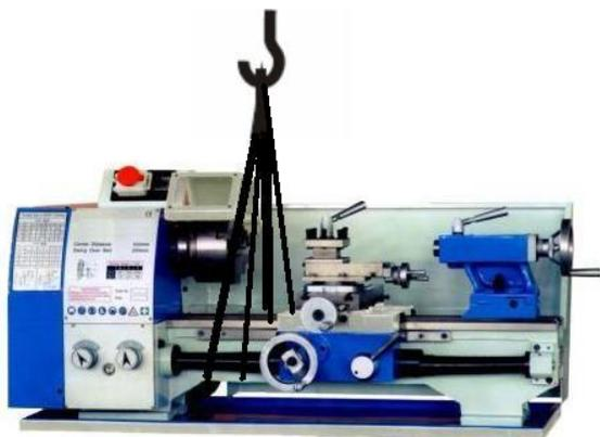
Перед транспортированием станка в распакованном виде необходимо убедиться в том, что перемещающиеся узлы (задняя бабка и каретка суппорта) надежно закреплены на станине. В местах прикасания каната к станку нужно установить деревянные прокладки (канат не должен прикасаться к защитному кожуху ходового винта). При транспортировании к месту установки и при опускании на фундамент необходимо следить за тем, чтобы станок не подвергался сильным толчкам и сотрясениям. ( см. рис.).
