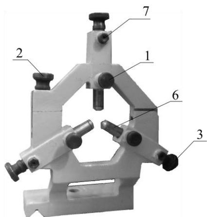
Неподвижный люнет устанавливается на станину в необходимом месте и закрепляется с помощью прижимной планки, болта и гайки. Для установки детали в люнет ослабьте стопора 1 направляющих пальцев 6 и выкрутите направляющие пальцы до упора, ослабьте гайку 2, откиньте фиксатор и поднимите верхнюю часть люнета, установите деталь в зажимной патрон, поставьте на место верхнюю часть люнета на место и зафиксируйте ее. Подведите
