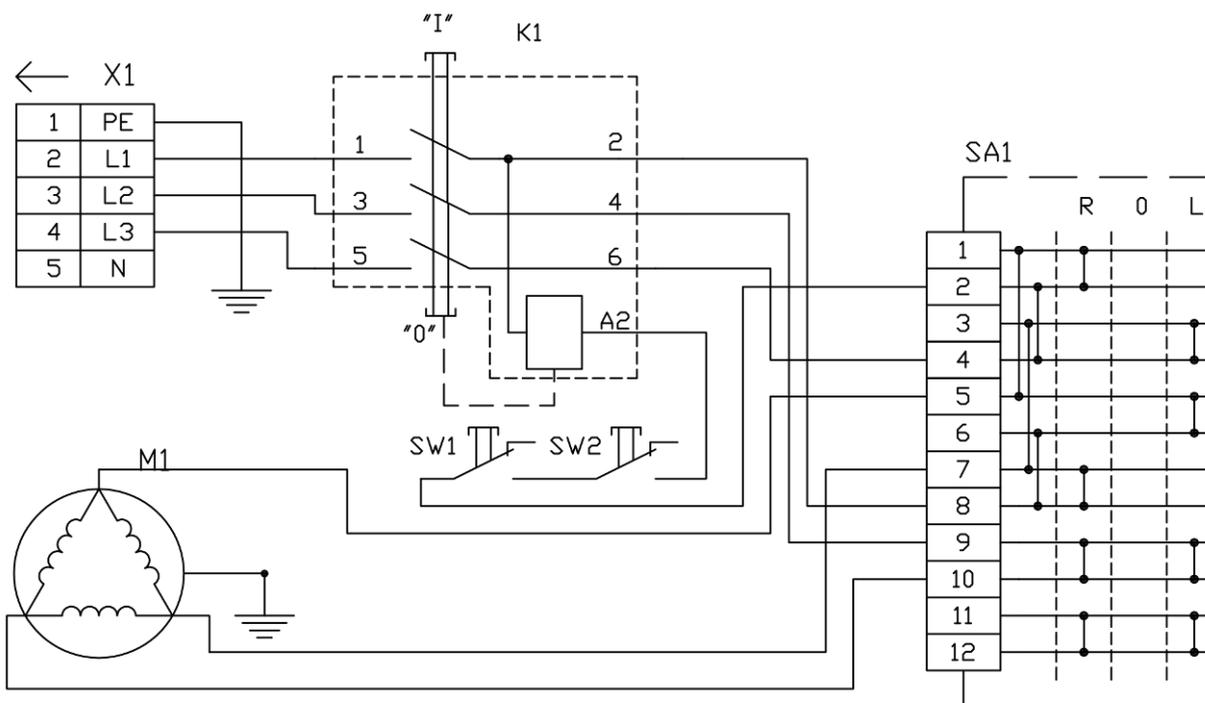
SW1 - Концевой выключатель защитного стекла
